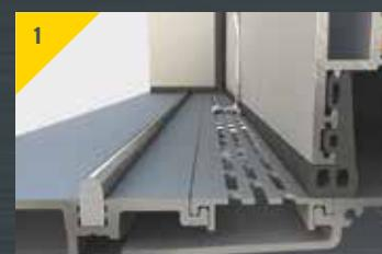
2 Specijalni ventil za drenažu vode postavljen ispod centralnog preklopog profila, omogućavajući visok nivo vodonepropustljivosti.
